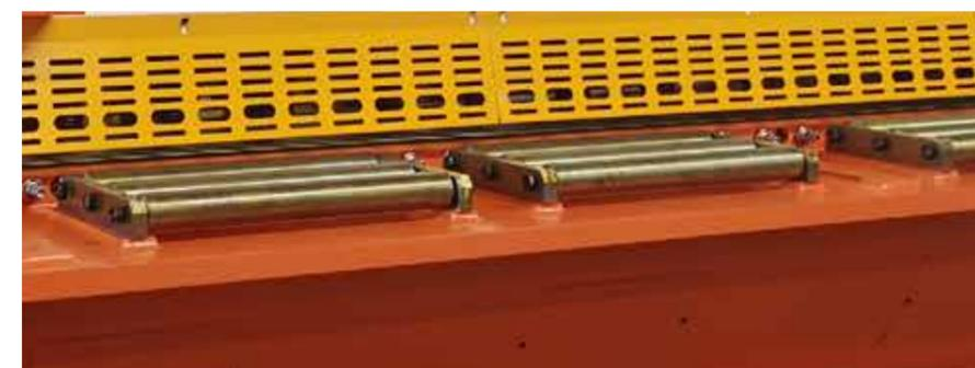
La plataforma de alimentación utiliza un mecanismo de transferencia por rodamientos para facilitar el desplazamiento de las placas de acero
