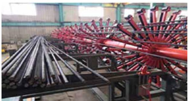
Estructura para almacenar barras longitudinales con capacidad de carga de hasta 7 Tn. El rack de almacenamiento dispone de topes controlados electrónicamente, dosificando la carga con absoluta eficacia y seguridad. Cuatro discos de apoyo para las barras longitudinales conectados a un eje fijo muy robusto y brazos con tubos giratorios para facilitar las maniobras de alimentación.
