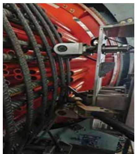
El robot automático de soldadura se encuentra ubicado sobre el lateral de la máquina, optimizando la gestión de soldadura y los procesos de ajustes. Los cabezales de soldadura se fijan simétricamente consiguiendo la máxima eficiencia en el proceso; mientras uno está cayendo el otro se predisponde para trabajar.
