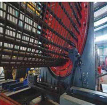
Unidad de inserción con guía hilo y enderezado para estabilizar su comportamiento, con capacidad de hasta 20mm. A diferencia de los sistemas convencionales, el hilo se introduce por debajo de la armadura facilitando el proceso de devanado y posterior soldadura. Un conjunto completo con devanador en posición horizontal y capacidad de carga de hasta 4.000Kg, y diámetro interior ajustable.
