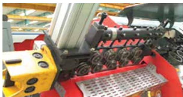
Sistema de inserción, sujeción y extracción de los hilos motorizado. Unidad de enderezado externo, con memoria mecánica para registro de los diferentes diámetros, cuenta con una serie de rodillos independientes que permiten la correcta alimentación para doble hilo.
