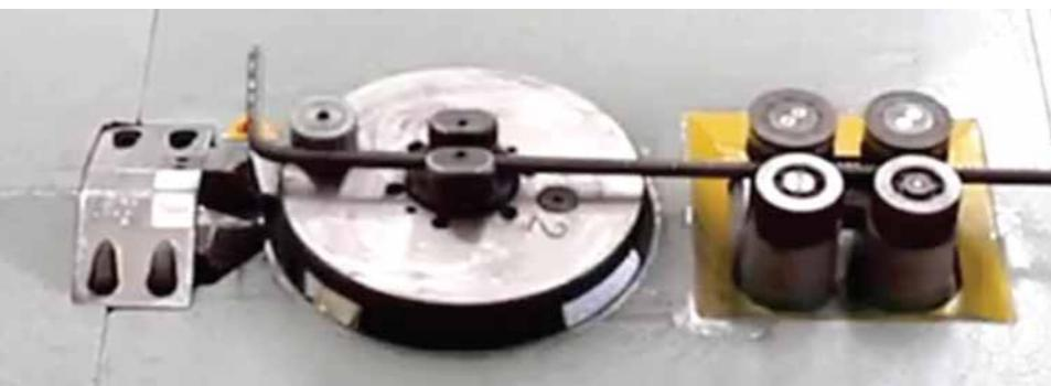
Sistema de doble tracción que posibilita el conformado de las **barras en ambos extremos** accionando el conjunto cizalla, disco y rodillos de forma sincronizada, los movimientos de traslación bidireccional permiten el correcto posicionamiento del hilo en la zona de doblado. La arquitectura de la WG16F-2 permite realizar estribos en pequeñas y grandes dimensiones.
