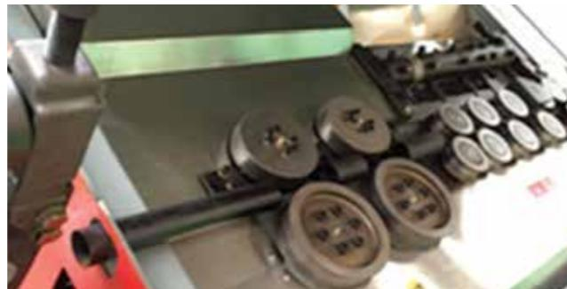
Rodillos de enderezado vertical con memoria mecánica de fácil ajuste, los últimos dos rodillos de **funcionamiento independiente** que permiten aplicar diferentes niveles de presión para cada línea. Las dos ruedas de tracción son accionadas por servomotor. El sistema de presión neumática garantiza que todos los hilos avancen por la unidad de alimentación sin dañar la superficie exterior, acompañado por sistema antideslizante para garantizar la tolerancia de longitud  $\pm 1\text{mm}$ .
